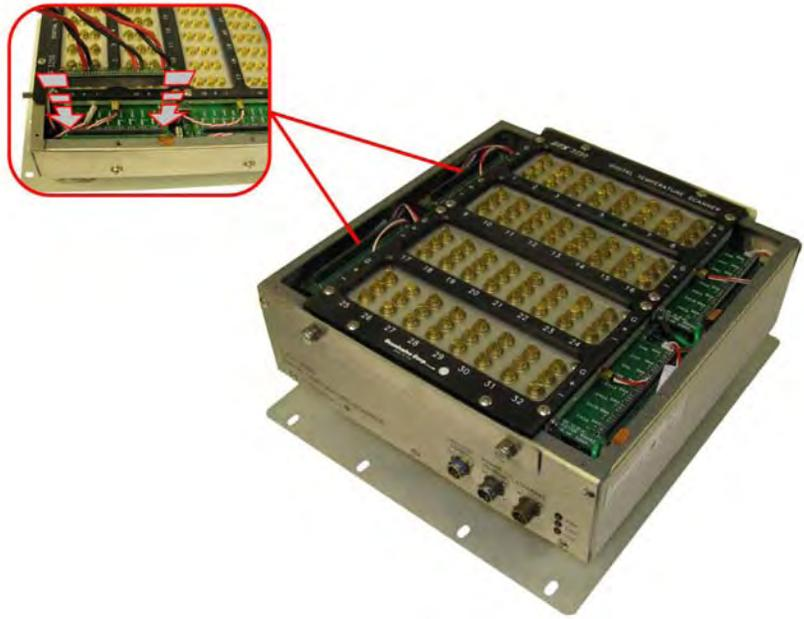
5) Install calibration harness connector #2 (2x)
